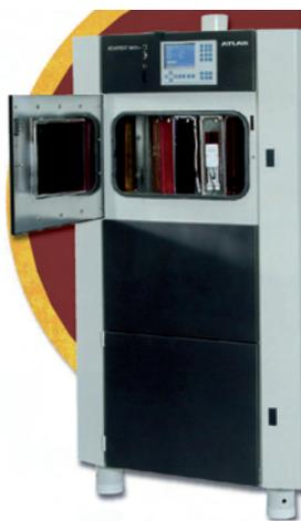
Abb. 2 - Klimakammer mit Xenon-Lampe für Alterungsprüfverfahren, die die Sonneneinstrahlung und die verschiedenen Witterungsbeeinflussung simulieren (Temperatur und Feuchtigkeit)
