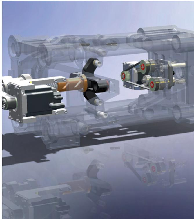
Die Schließeinheit der neuen Spritzgießmaschine IT mit 140t Schließkraft von Ripress
