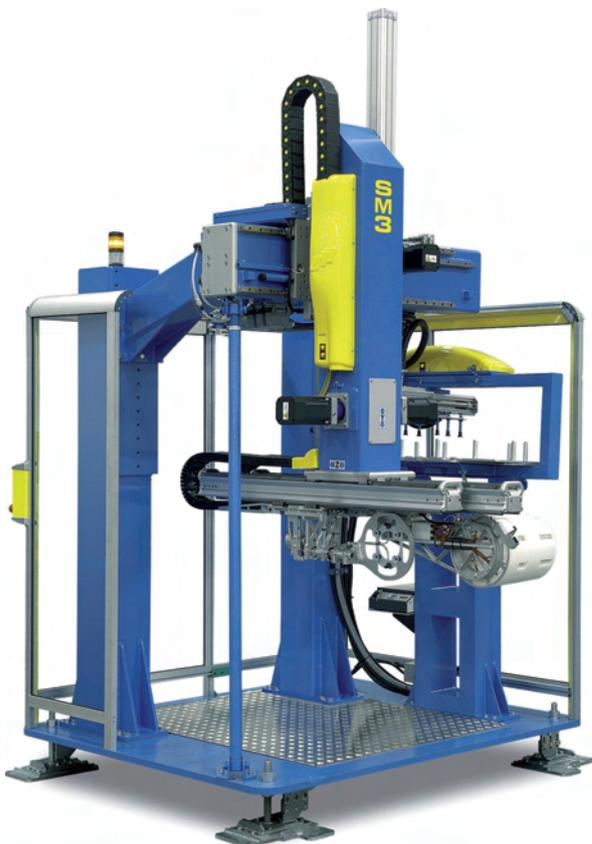
*Das Automationssystem mit Side-Entry Roboter, das von Competella für IML Anwendungen entwickelt wurde*
