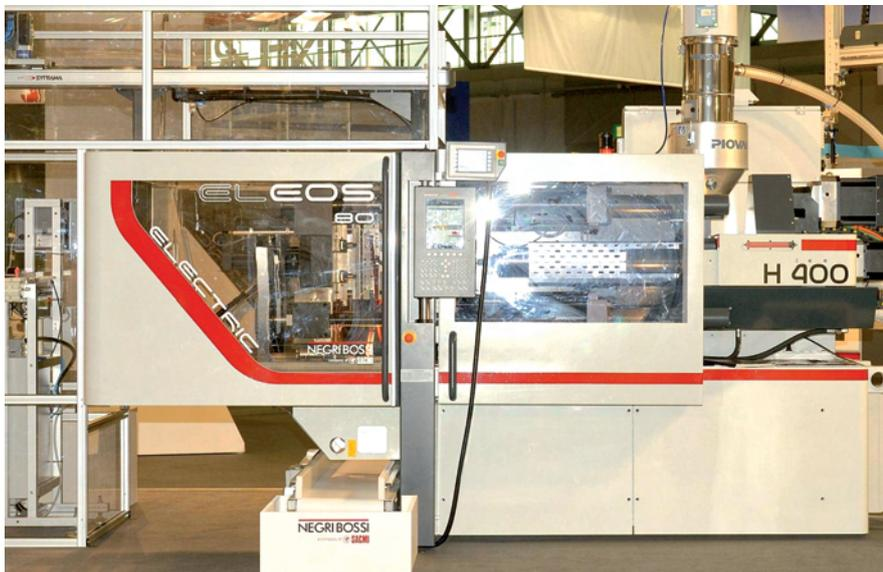
Die elektrische 80 t Spritzgießmaschine Eleos ist die Basis bei einer der beiden von Negri Bossi vorgestellten Fertigungszellen
