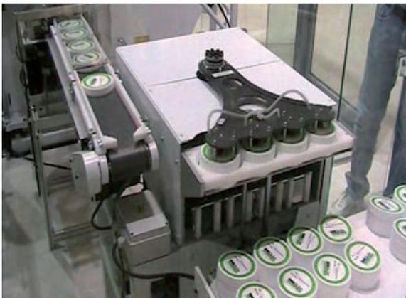
**Vorrichtung für Aufnahme der spritzgegossenen Artikel vom Förderband und für deren Stapelung**
