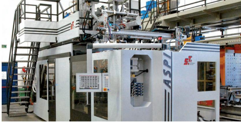
**Die Blasformmaschine Aspi 150, die von ST Soffiaggio Tecnica an das European Technical Centre der Firma Du Pont in Genf ausgeliefert wurde**
