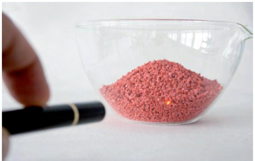
*Es wird die Präsenz des Polysecure Markers überprüft, mit seiner charakteristischen Farbe*
