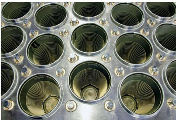
*Eine Detailansicht der Kavitätenanordnung auf dem Termostampi Werkzeug für Trinkbecher*
