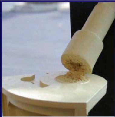
**Abb. 4 - Eine auf verringerten Nachdruck zurückzuführende Porösität sowie eine unzureichende Gate-Größe, verglichen mit der Wandstärke des Kunststoffteils**
