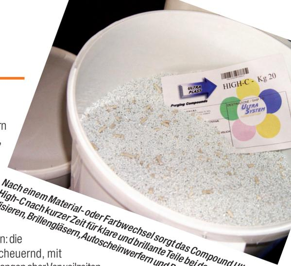
*Nach einem Material- oder Farbwechsel sorgt das Compound Ultra Plast High-C nach kurzer Zeit für klare und brillante Teile bei der Produktion von Visieren, Brillengläsern, Autoscheinwerfern und Deckenlampen*
