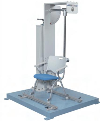
Abb. 3 - Stoßprüfverfahren an der Rücklehne eines Bürostuhls
